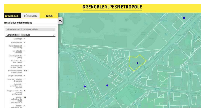
Illustration 3.4: Cadastre géothermique GAM (09/2023) : Détail pour BHT2 avec début des caractéristiques techniques enregistrées
